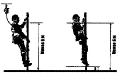
В качестве соединительно-амортизирующих устройств в составе страховочных систем для снижения риска травмирования работников и в случае, если запас высоты при использовании стропов с амортизаторами не достаточен, должны использоваться средства защиты ползункового типа на жесткой анкерной линии (схема 3) или средства защиты от падения втягивающего типа (схема 3.1).
