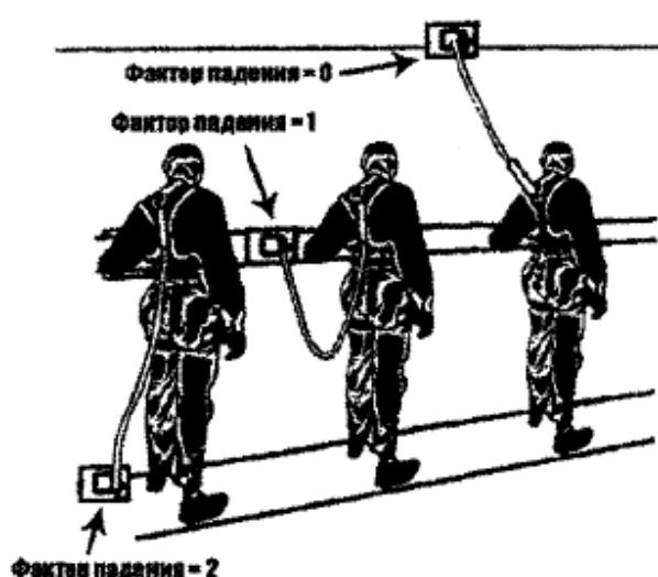
остановки падения, зависит от фактора падения, определяемого отношением значения высоты падения работника до начала остановки или начала торможения падения из-за воздействия соединительной подсистемы, в том числе начала срабатывания амортизатора, (при его наличии), к суммарной длине подсистемы.
